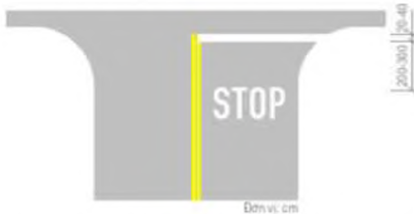
Hình G.48 - Vạch dừng xe tại nút giao không có tín hiệu đèn điều khiển
