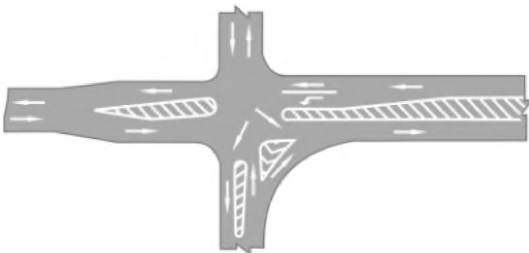
Hình G.35 - Bố trí kênh hóa dòng xe ở ngã tư phức tạp
