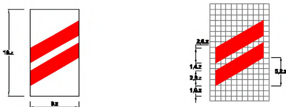
Biên số W.243b: Nơi đường sắt giao không vuông góc với đường bộ
