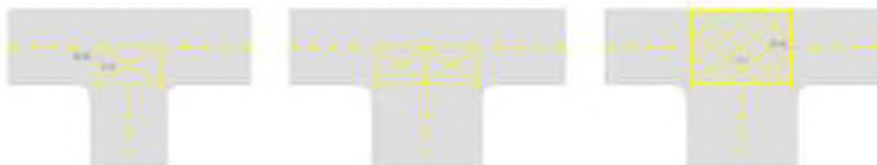
Hình G.38 - Minh họa bố trí vạch kẻ kiểu mắt võng tại nút giao ngã tư
