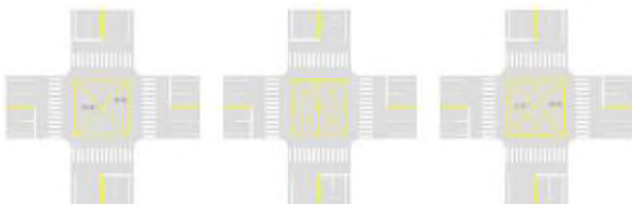
Hình G.38 - Minh họa bố trí vạch kẻ kiểu mắt võng tại nút giao ngã tư
