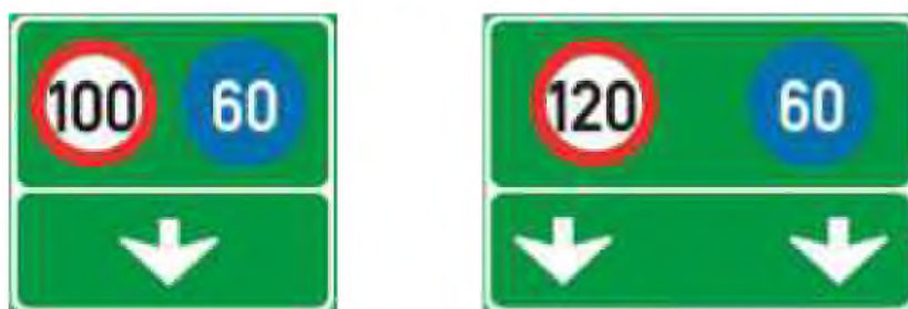
Hình 9b - Biển chỉ dẫn bắt đầu đường cao tốc phân làn đường có tốc độ khác nhau
