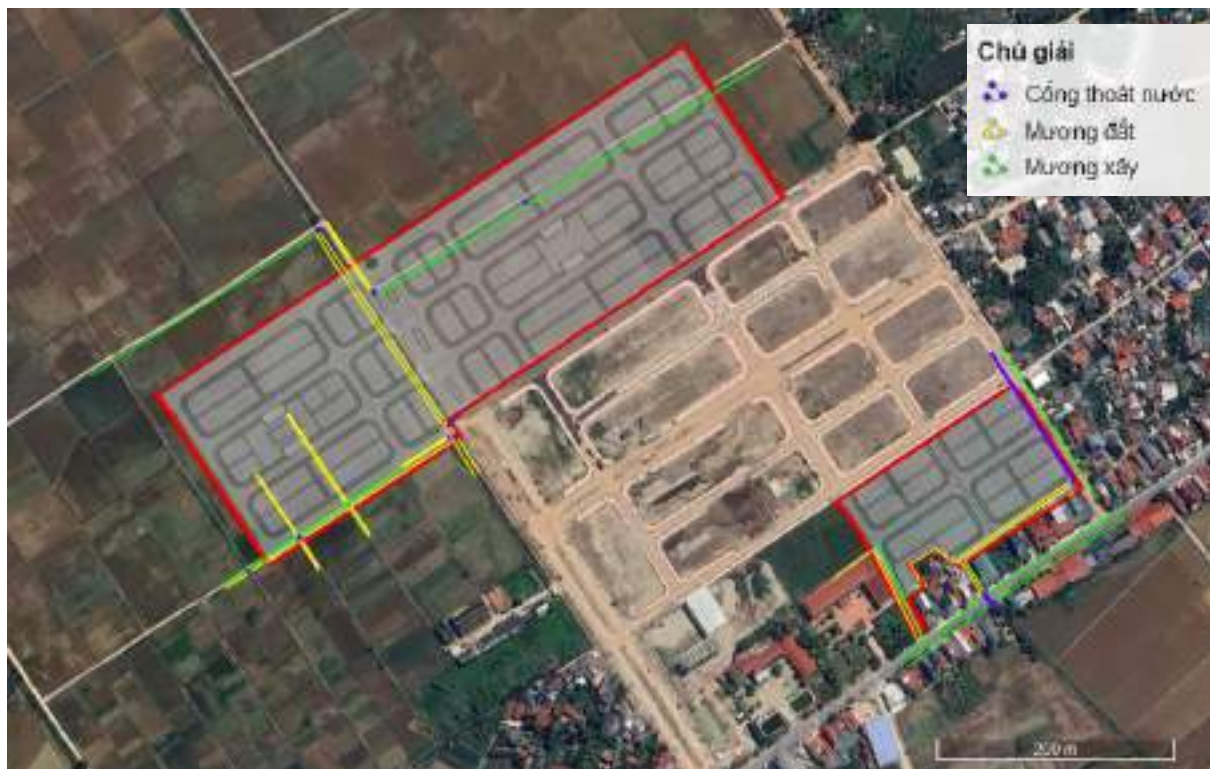
Hình 11. Hiện trạng hệ thống kênh mương thoát nước tại khu vực dự án
