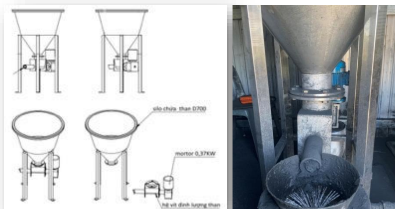
Hình 3. 24. Silo chứa than
