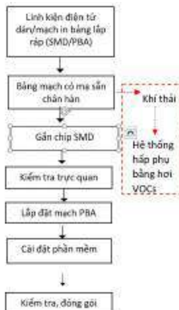
Hình 1. 3. Quy trình sản xuất bảng mạch
