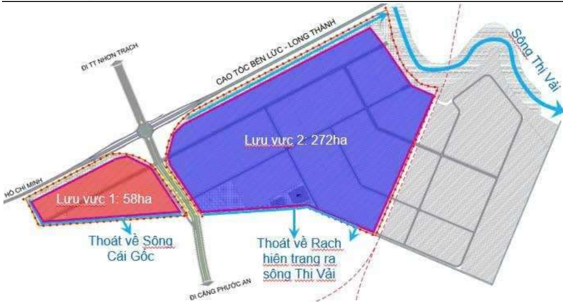
Hình 1.5. Sơ đồ phân lưu vực thoát nước
