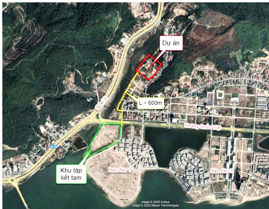
Hình 1.3: Vị trí khu vực tập kết tạm trên bán đảo số 1 và cung đường vận chuyển
