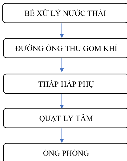
Hình 4.2.Sơ đồ Quy trình công nghệ xử lý khí thải tại trạm XLNT của dự án
