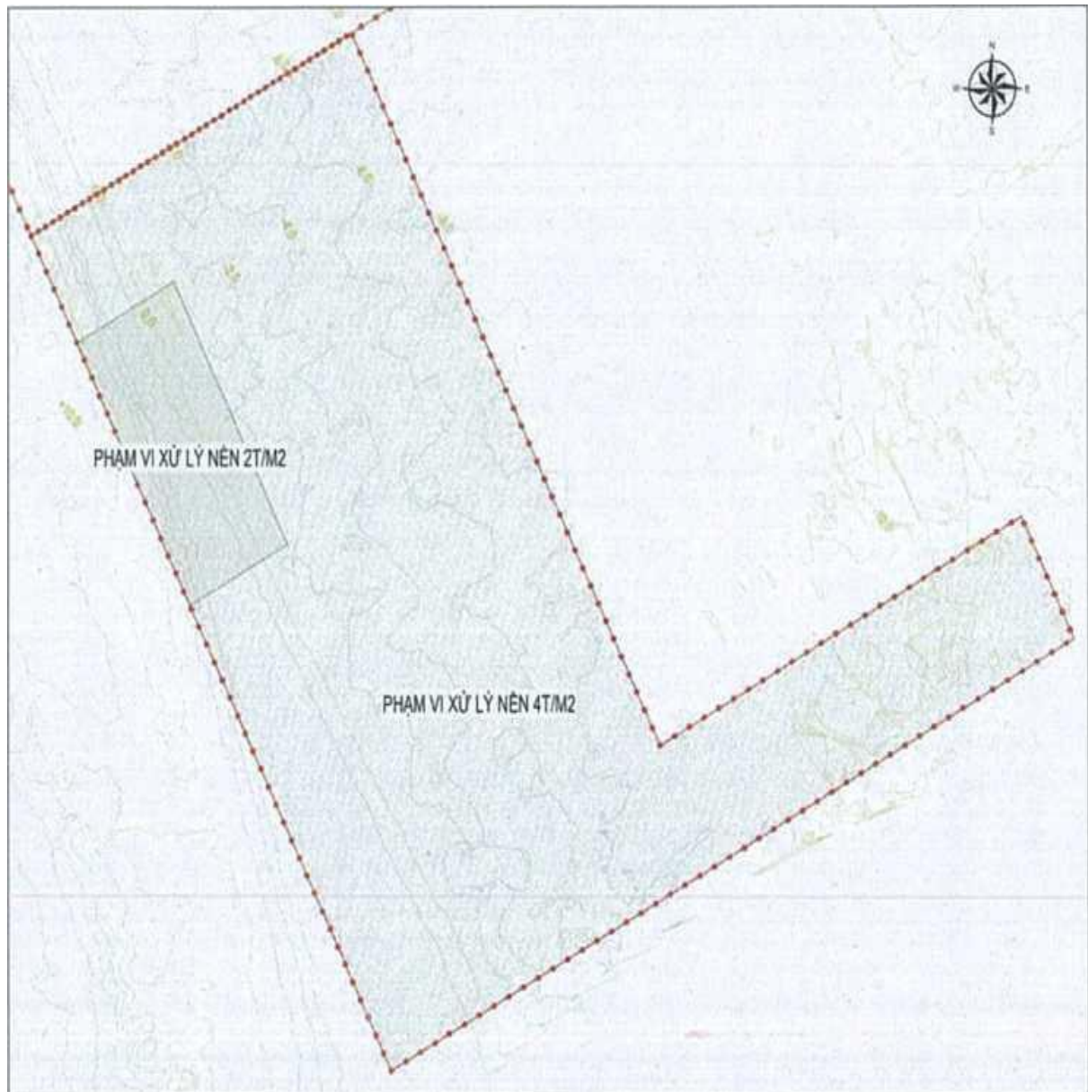
Hình 1.14. Mặt bằng phạm vi xử lý nền
