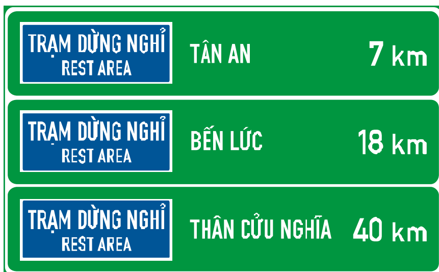
Hình 17 - Biển số IE.458 chỉ dẫn khoảng cách đến trạm dừng nghỉ tiếp theo
