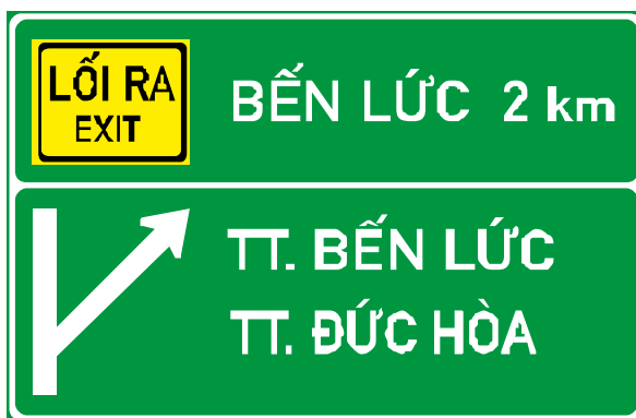
Hình 11 - Biển số IE.454 chỉ dẫn khoảng cách đến lối ra phía trước
