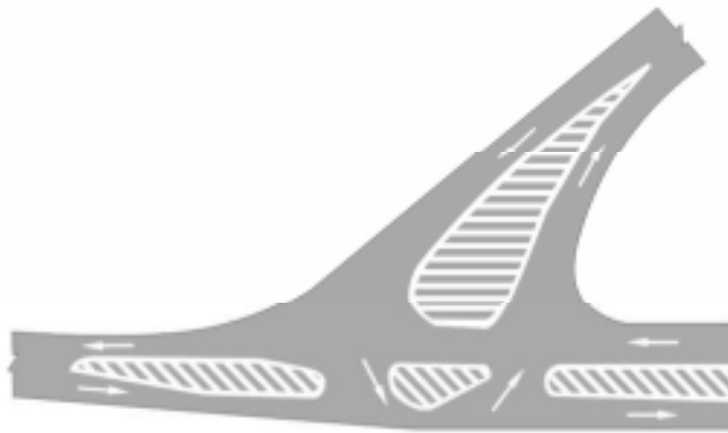
Hình G.31 - Bố trí vạch kênh hóa dòng xe ở ngã ba phức tạp – Mẫu 2
