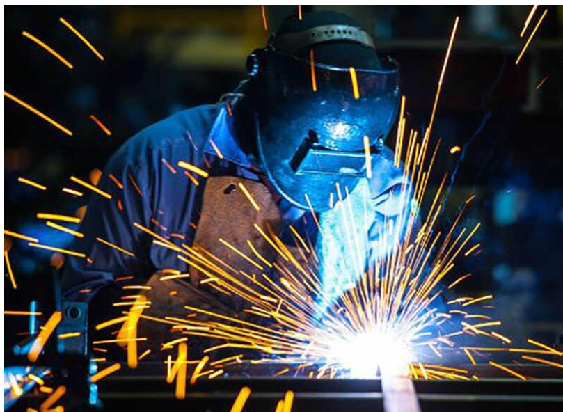
Hình 4. 4. Minh họa công nhân được trang bị đầy đủ mặt nạ khi thực hiện hàn cắt kim loại
