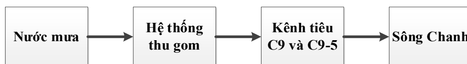
Hình 3.1: Sơ đồ minh họa quy trình thu gom, thoát nước mưa của KCN Bảo Minh
