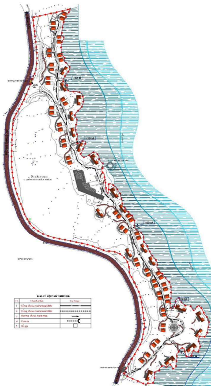
Hình 1.10. Thoát nước mưa khu vực dự án
