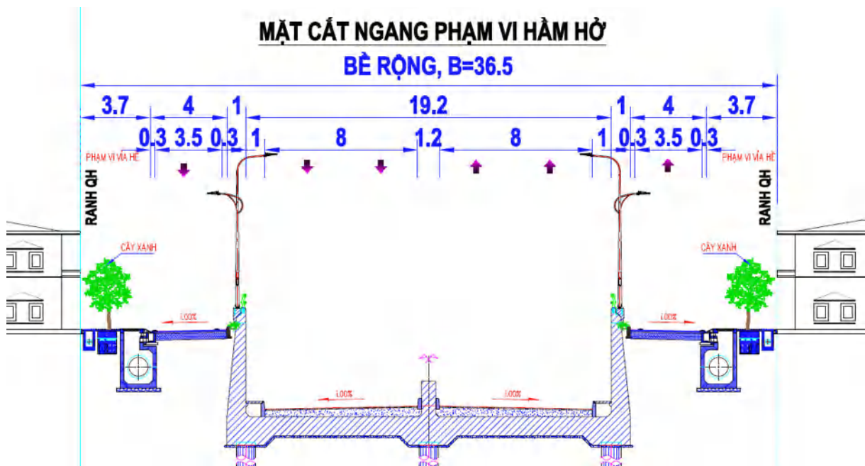
Hình 1-52. Mặt cắt ngang tại nút giao NE8
