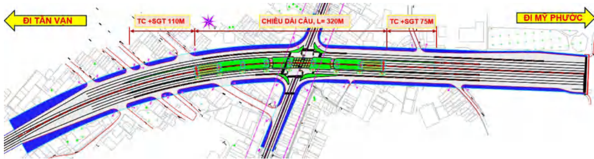
Hình 1-35. Mặt bằng tại nút giao Phú Lợi
