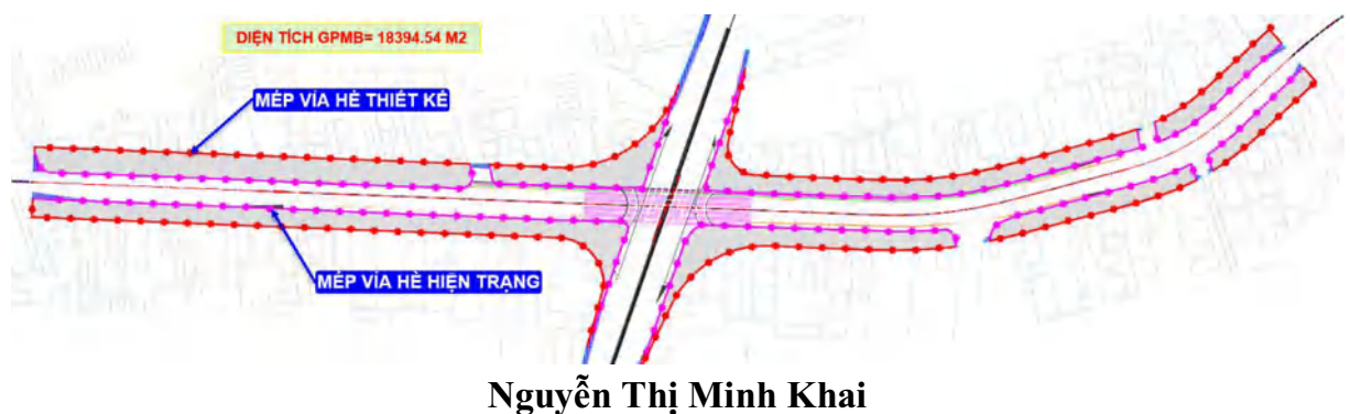
Hình 1-24. Phạm vi giải phóng mặt bằng tại nút giao đường Nguyễn Thị Minh Khai
