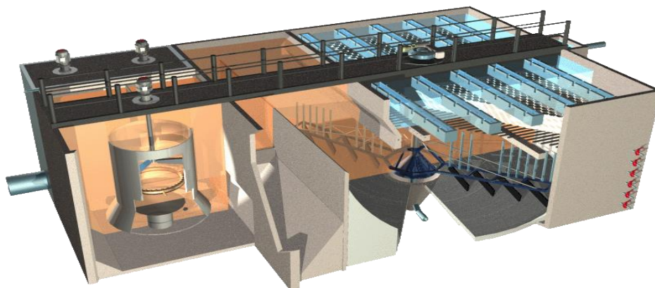
Hình 3. 4. Sơ đồ kết cấu hệ thống xử lý nước thải sản xuất
