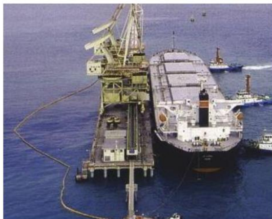
Hình 2: Giải pháp thực hiện chống tràn dầu trong vận hành khai thác
