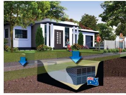
Mô hình bể tích trữ nước mưa trên đường giao thông
