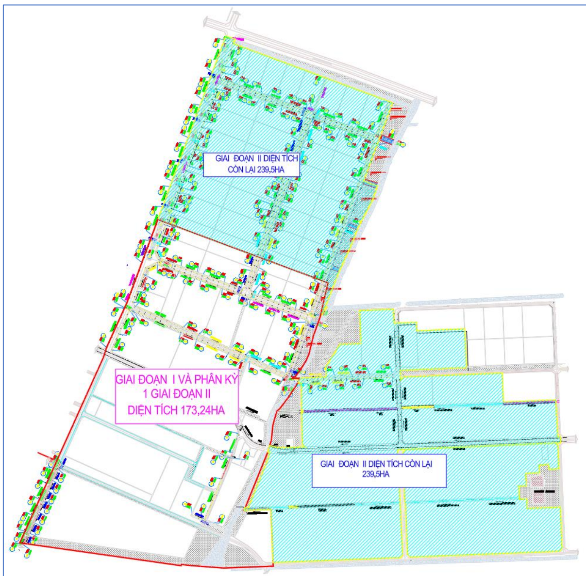
Hình 3.2: Mặt bằng thoát nước mưa đã xây dựng hoàn thiện của KCN
