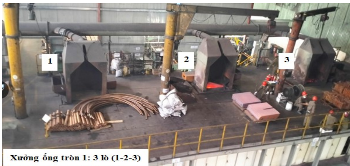
Hình 1.11. Mặt bằng bố trí 3 lò nung tại xưởng ống tròn 1
