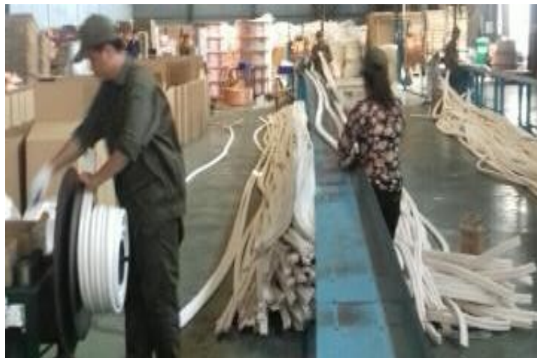
Hình 1.22. Công đoạn bọc ống bảo ôn cho ống tròn
