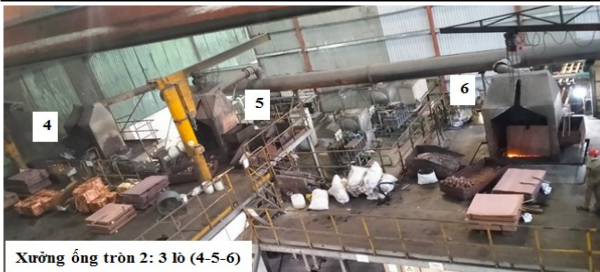
Hình 1.12. Mặt bằng bố trí 3 lò nung tại xưởng ống tròn 2
