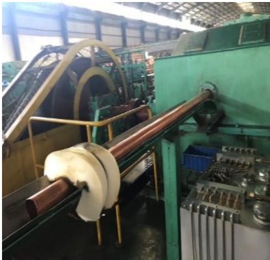
Hình 1.15. Máy kéo và bể chứa nước tuần hoàn tại công đoạn kéo nhỏ
