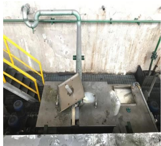
Hình 1.15. Máy kéo và bể chứa nước tuần hoàn tại công đoạn kéo nhỏ
