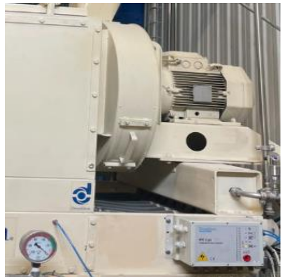
Bộ hút bụi ở hệ thống nghiền malt và gạo 14 mẻ/ngày
