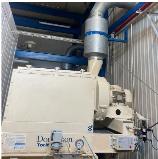
Bộ hút bụi ở hệ thống nghiền malt và gạo 14 mẻ/ngày
