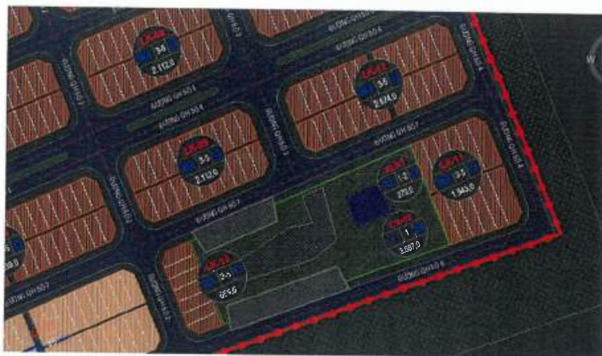
Hình 25. Vị trí xây dựng trạm XLNT tập trung
