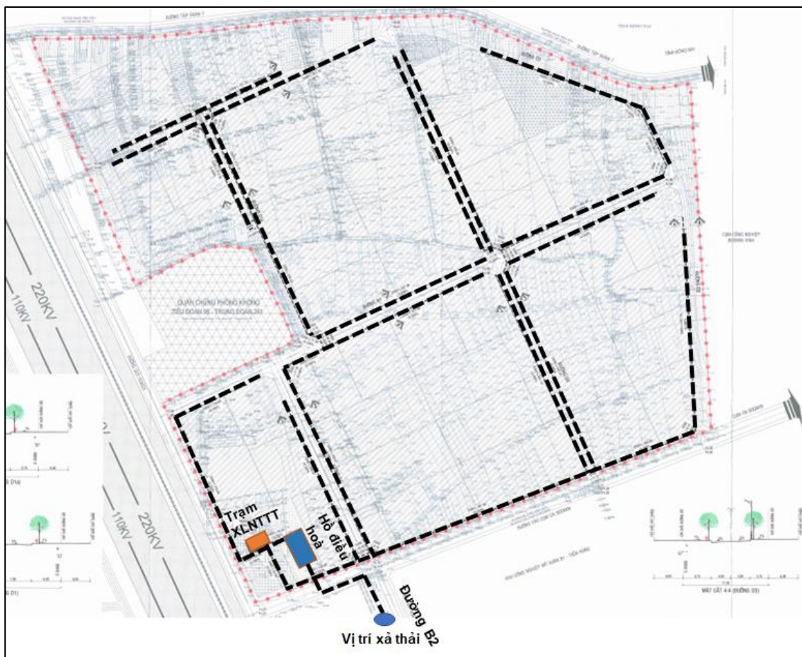
Hình 1. 13. Sơ đồ thu gom, thoát nước thải tại dự án
